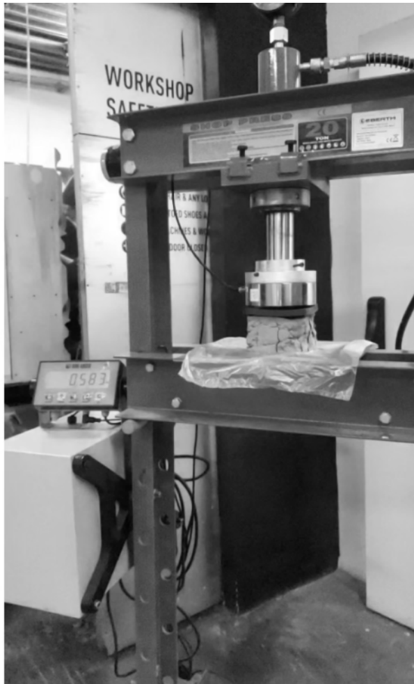
Test di carico effettuati su provini in terra cruda: test 1 di resistenza a compressione, test 2 prova a flessione in 3 punti
