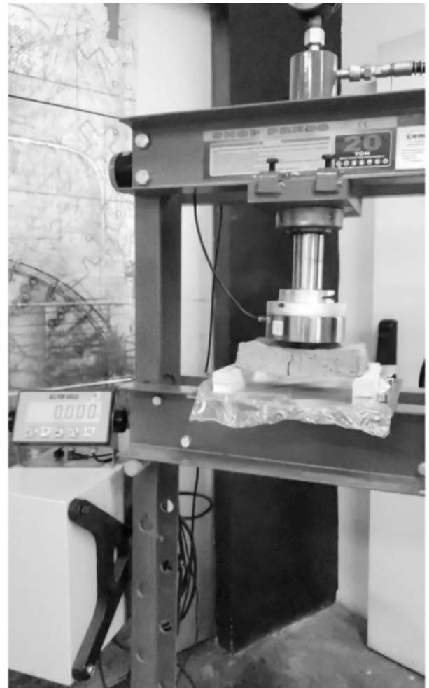
Test di carico effettuati su provini in terra cruda: test 1 di resistenza a compressione, test 2 prova a flessione in 3 punti
